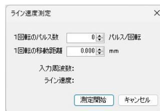
エンコーダーの「1回転のパルス数」「1回転の移動距離」を入力して実ラインを動かして「測定開始」ボタンを押すと、エンコーダー信号の入力周期とライン速度が表示されます。
