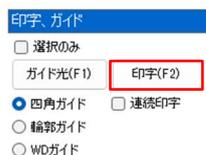
連続印字 にチェックをして印字ボタンを押すと、停止するまで「印字を連続」で繰り返します。
