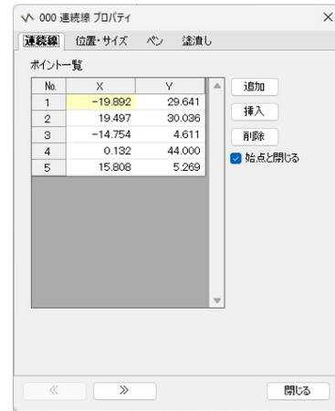
例えば1点の座標を変更して図形を変形することができます。
