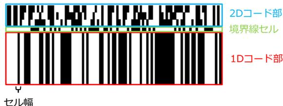
セル幅、境界線セル高さ、1Dコード部高さ、2Dコード部高さを適切に調整して下さい。
