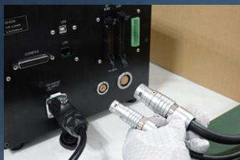
着脱式ケーブルにより印刷機への設置が容易に
