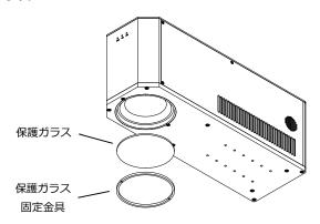
※保護ガラス固定金具の取り外しには、先端がマイナス形状のカニ目 レンチをご使用ください。
