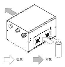
エアーブローは上図のように運転時の空気の流れと同じように吹きかけると埃が外部に押し出され、より効果的です。
