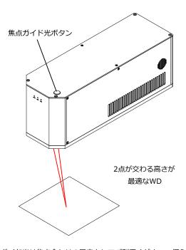
焦点ガイド光は焦点合わせの目安としてご利用ください。何らかの 理由で焦点が若干合っていない場合は、印字結果を確認して最適な 位置に調整してください。
