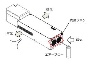
エアーブローは上図のように運転時の空気の流れと同じように吹きかけると埃が外部に押し出され、より効果的です。
