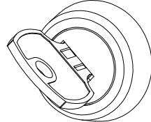
キースイッチをONの位置に回転後、約 5 秒後にシステムが起動します。
