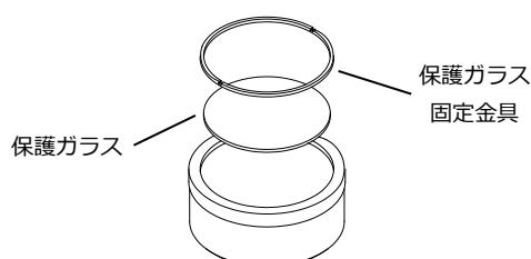
※保護ガラス固定金具の取り外しには、先端がマイナス形状のカニ目レンチをご使用ください。
